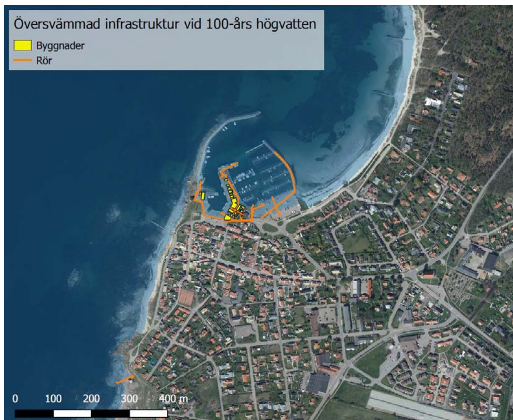
Figur 5-7 Översvämmad infrastruktur i Torekov vid ett 100-årshögvatten år 2015 (+2,1 m RH2000).
