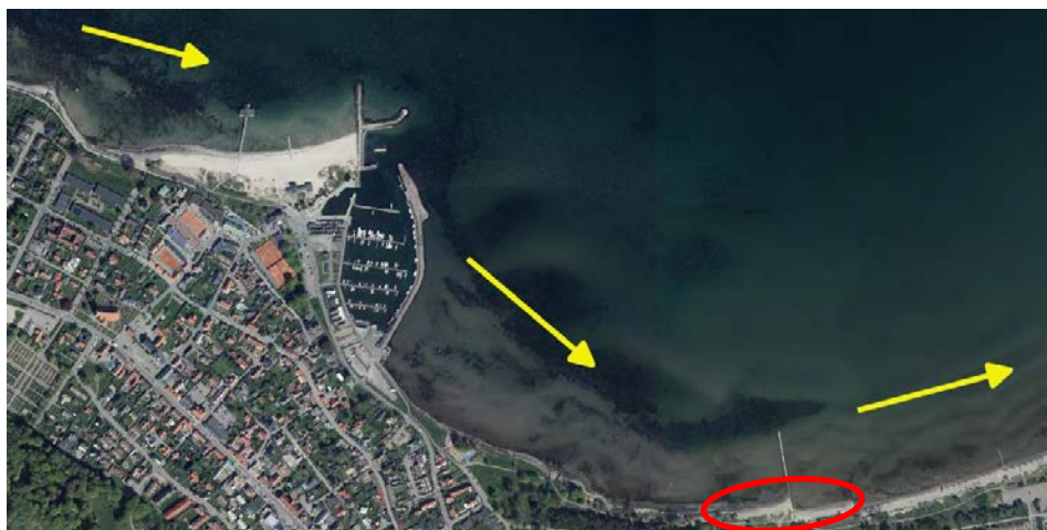
Figur 4-8 Bedömd förhärskande riktning för sedimentets rörelse omkring Båstad. Effekten av bryggor/hövder i området kan ses i den röda ovalen, där sand ackumulerar väster om konstruktionerna.
