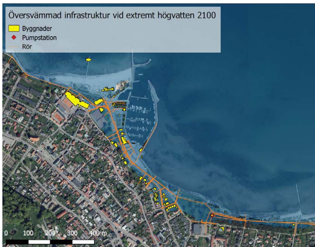
Figur 5-10 Översvämmad infrastruktur i Båstad vid ett extremt högvatten år 2100 (+3,4 m RH2000).
