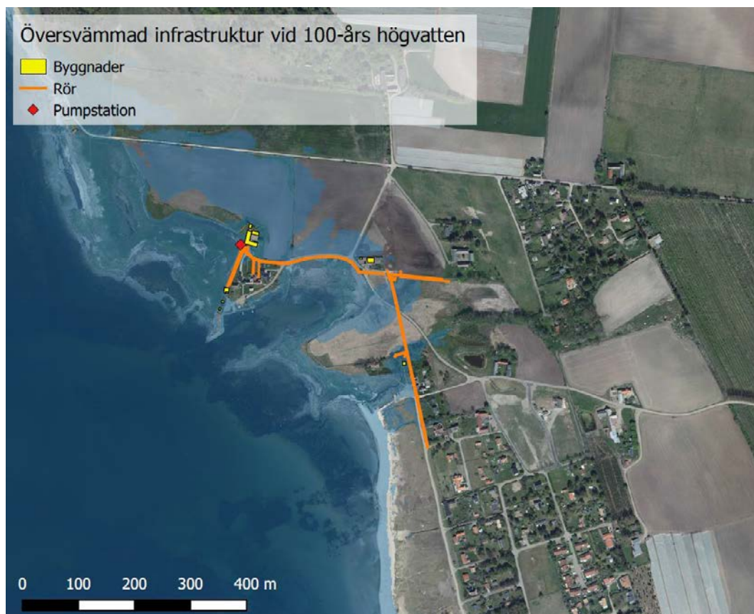
Figur 5-3 Översvämmad infrastruktur vid Stora Hults strand vid ett 100-årshögvatten år 2015 (+2,1 m RH2000).
