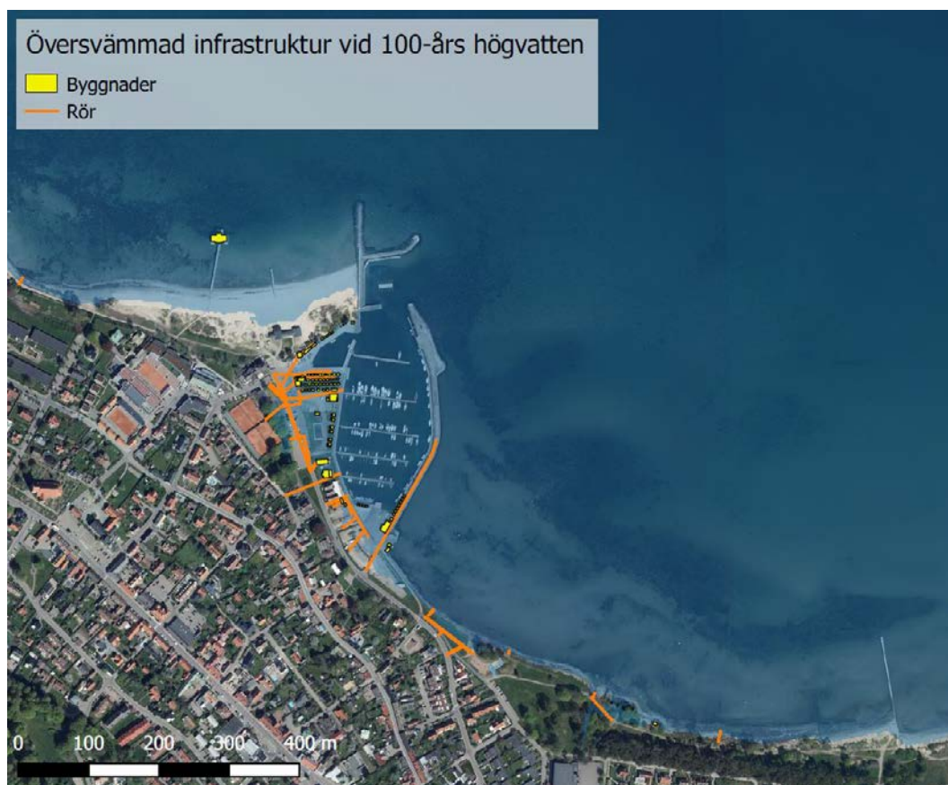
Figur 5-9 Översvämmad infrastruktur i Båstad vid ett 100-årshögvatten år 2015 (+2,1 m RH2000).
