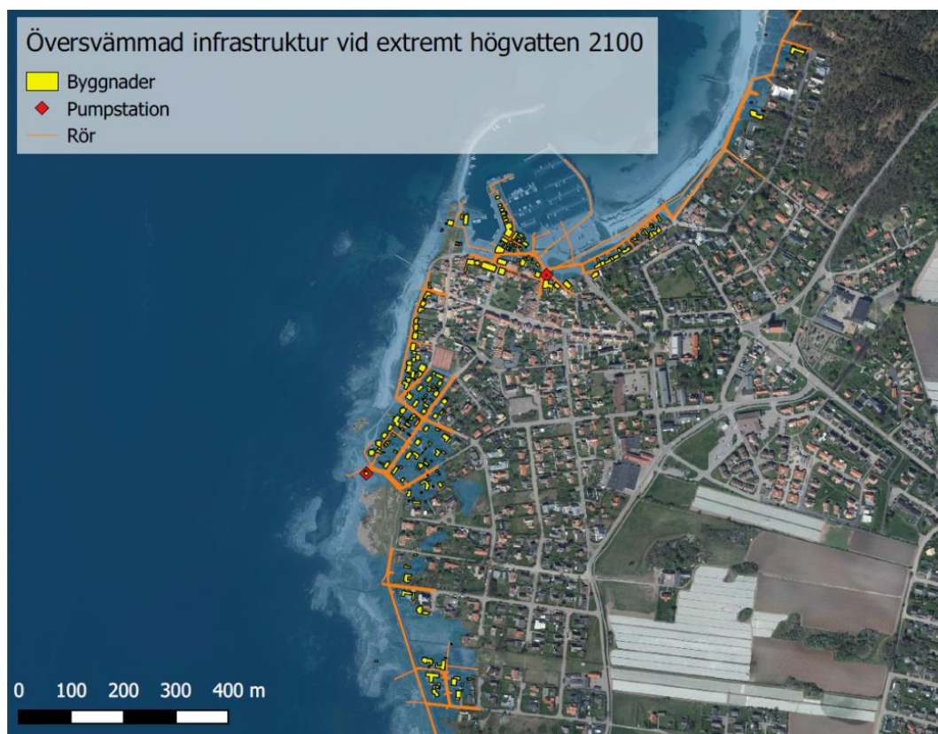
Figur 5-8 Översvämmad infrastruktur i Torekov vid ett extremt högvatten år 2100 (+3,4 m RH2000).
