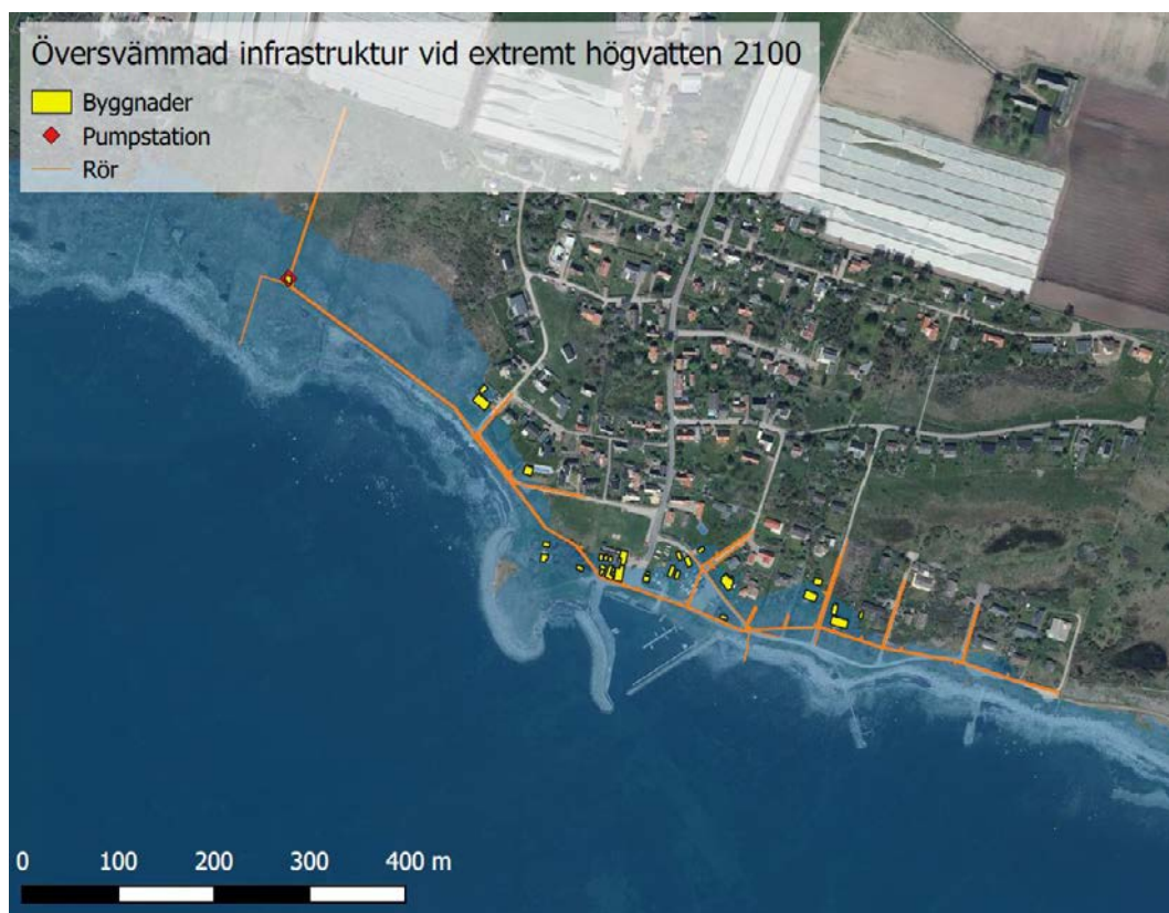
Figur 5-6 Översvämmad infrastruktur vid Rammsjöstrand strand vid ett extremt högvatten år 2100 (+3,4 m RH2000).
