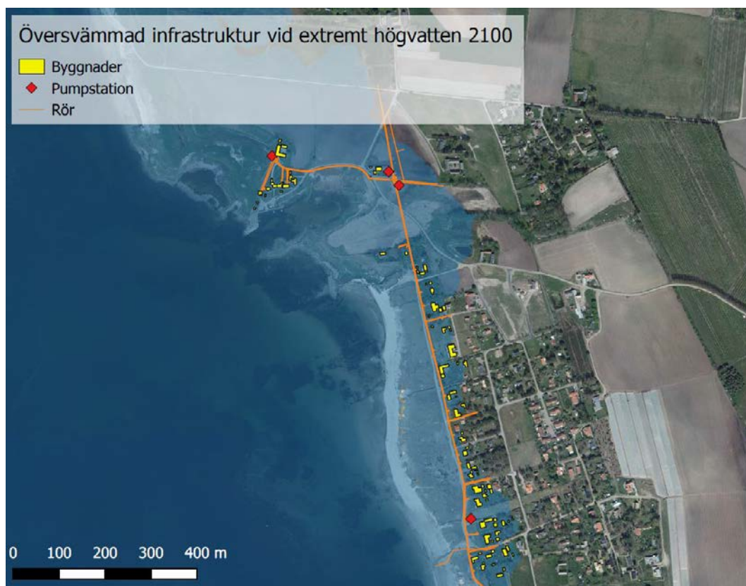
Figur 5-4 Översvämmad infrastruktur vid Stora Hults strand vid ett extremt årshögvatten år 2100 (+3,4 m RH2000).
